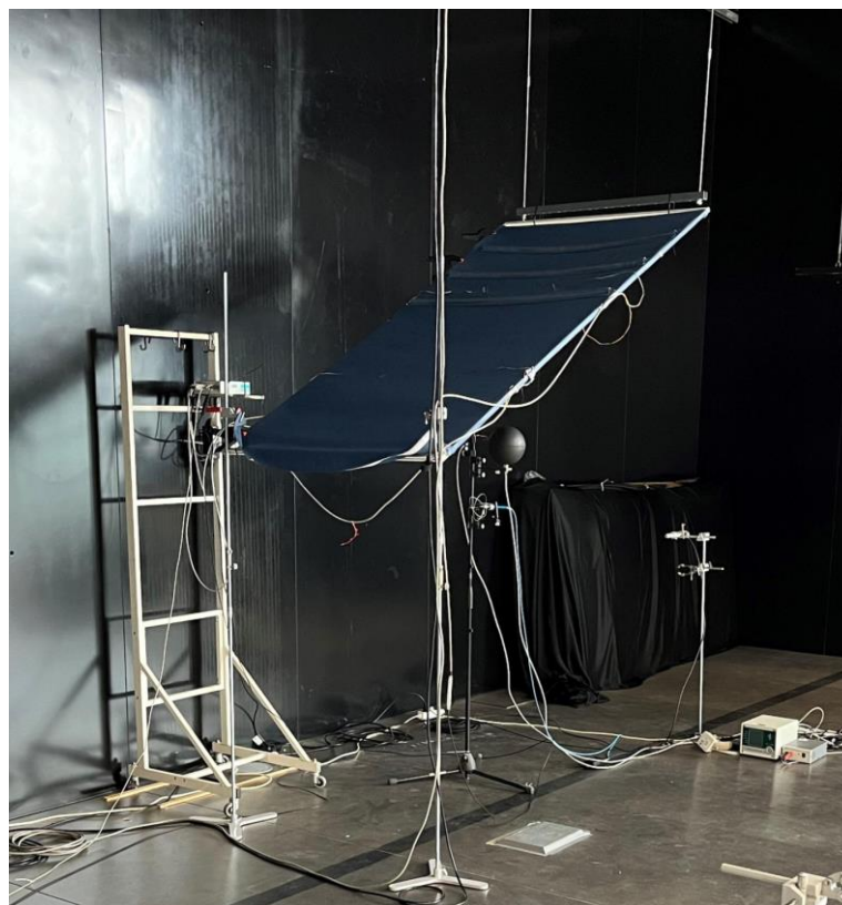
Abbildung 4: Projekt Kühlpavillon – Laborversuch zur Testung der Verdunstungseigenschaften von „Zeltstoffen“
