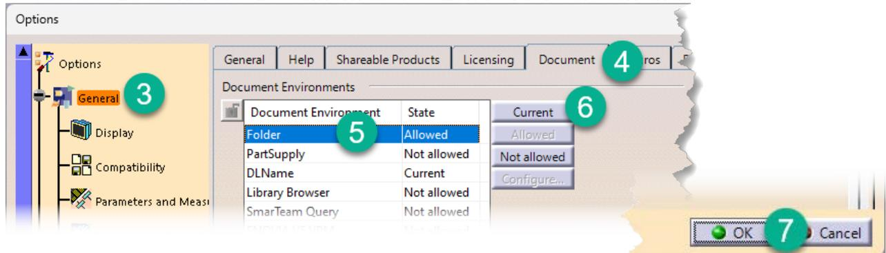
Im **3DX-RICH-Client (CATIA V6)** speichern Sie die Daten prinzipiell in der Datenbank im aktuellen **Collaboration Space (Teamarbeitsbereich)**. Beim **Import und Export von Daten** in bzw. aus der Datenbank heraus kann auch mit DLNames oder mit Filezugriff gearbeitet werden. Hier erfolgt die Einstellung über **Preferences** im 3DX-RICH-Client:
