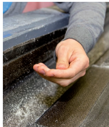
Ein Teil aus Basaltfaser vor dem Entformen.
