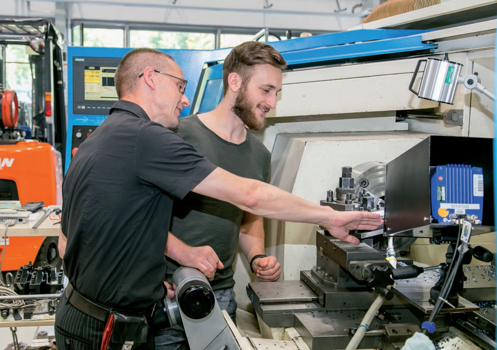
Dr.-Ing. Jan Glühmann (links) mit Student Jakob Riemer an der CNC-Drehmaschine DUS560ti. Diese Werkzeugmaschine dient im Projekt der Abbildung aller kryogenen Drehoperationen.
