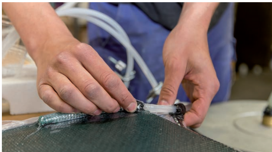
Die Harzinfusion von Basaltfasern mit Epoxidharz erfolgt unter Vakuum.
