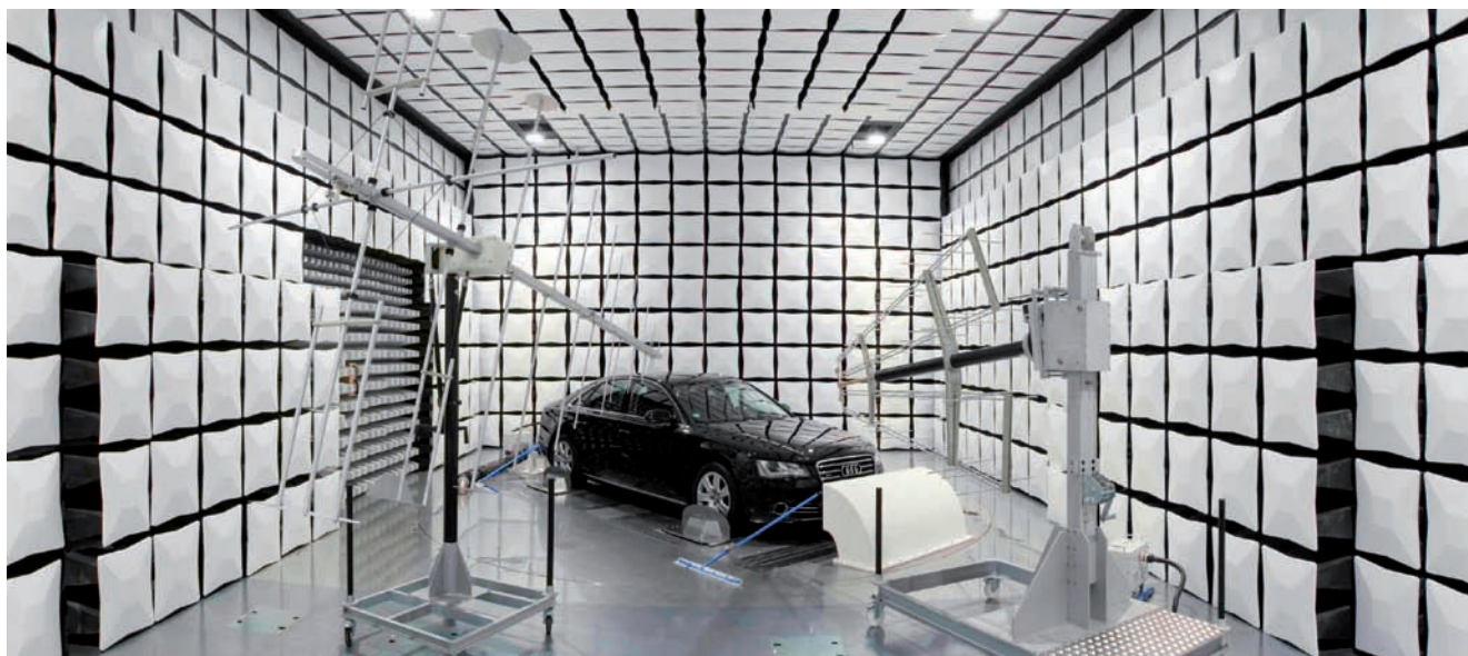
Im WHZ-Labor wird ein Auto hinsichtlich der elektromagnetischen Verträglichkeit untersucht.
