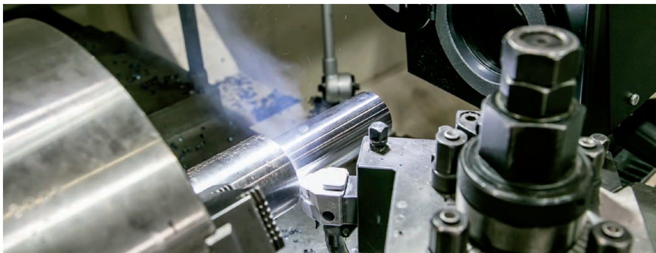
Eine Temperaturmessung beim Drehen eines Stahlwerkstoffes mit Kohlenstoffdioxid in der Drehmaschine.
