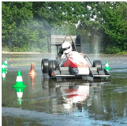
Vorbereitungen fürs Wet Pad - auch das für Hockenheim besondere dynamische Event wird auf unserem Testplatz geübt. Dabei wird die Querbeschleunigung auf nasser Fahrbahn getestet. Bei heißem Sommerwetter bietet das kühle Nass eine besondere Abkühlung.
